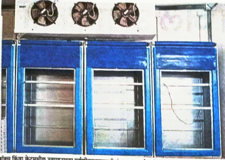
बॉक्स किंवा क्रेटमधील उत्पादनाच्या पूर्वशीतकरणासाठी यंत्रणा. या समोर बॉक्स एकावर एक ठेवून आतमधील पंखे चालू केले जातात. ते बॉक्समधील उष्ण हवा खेचून घेतात. तिथे शीतकझातील थंड हवा भरली जाते.
